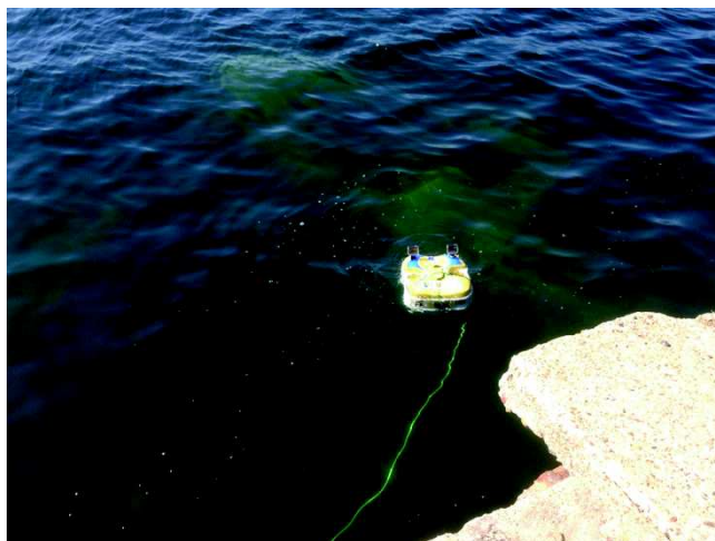
Figure 5-15 : Le robot Jack équipé du sonar profilométrique et des caméras Go-Pro
