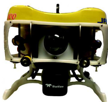
Figure 5-7 : Jack équipé de la caméra acoustique installé sur le skid luge
