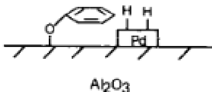
Figure 1-27 : Adsorption du composé phénolique et activation de l' H_2 sur Palladium [86].
