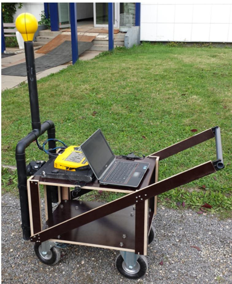
FIGURE 2.6 – Système d'acquisition de mesure de champ électromagnétique
