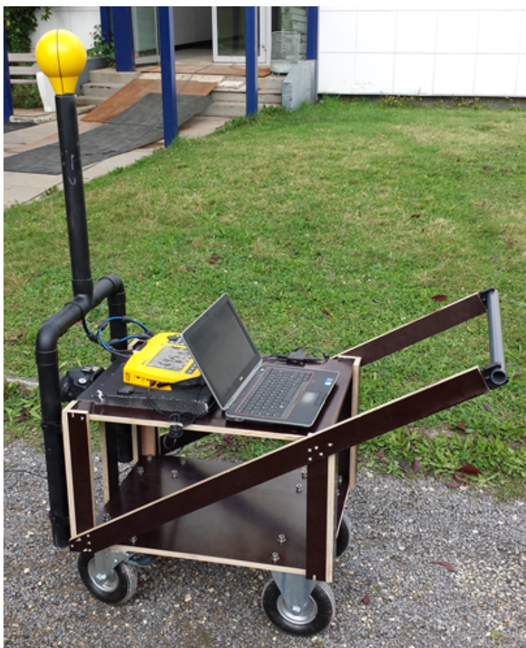
FIGURE 2.6 – Système d'acquisition de mesure de champ électromagnétique
