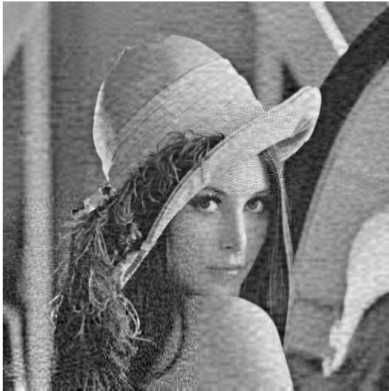
(a) Décodage arithmétique classique. Décodage RS classique. CA : p = 0 , RS : p = 0 , PSNR = 26.25 dB.
