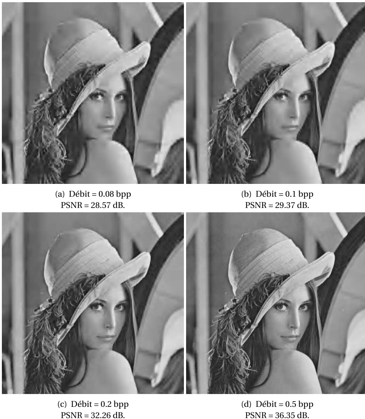
FIGURE 1.7 – Illustration du concept de progressivité dans le codage de l'image "lena" par l'algorithme JPEG2000.
