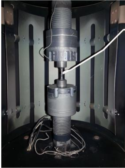
Figure II-23 : Exemple de montage d'une éprouvette sur l'équipement Instron 1271 - un thermocouple est soudé en surface. Les éprouvettes testées ont subi la même préparation de surface que les essais précédents à savoir un polissage mécanique manuel jusqu'au papier SiC x2000.
