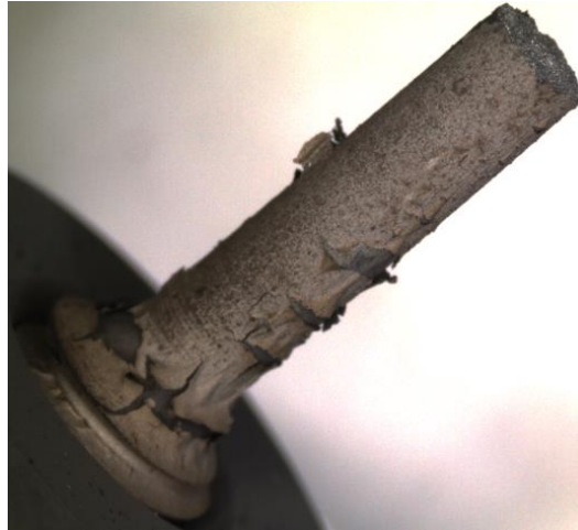
Figure V-16 : Ecaillage d'une couche carbonée en surface de l'éprouvette du lot 3_d60-1315C-75MPa-2min_I p. laboratoire 1,05 Al testée à 1000°C / 45 MPa sous vide
