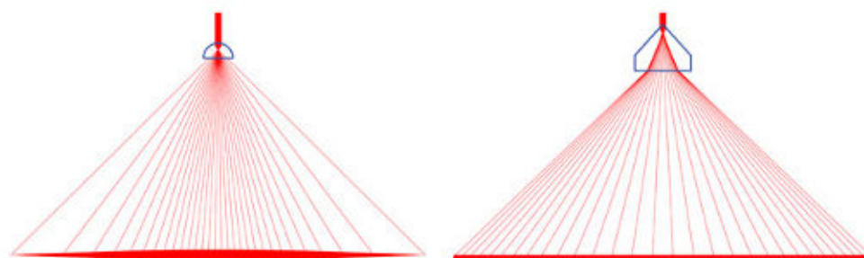
Figure 2.16 – Schéma d’éclatement de faisceau en nappe, à gauche : lentille cylindrique, à droite : lentille de Powell.
