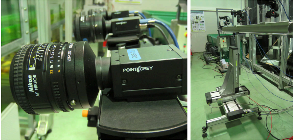
Figure 2.18 – À gauche : Les trois caméras servant à l’acquisition de la ligne laser. À droite : Table de déplacement 3 axes servant de support pour le positionnement des caméras.
