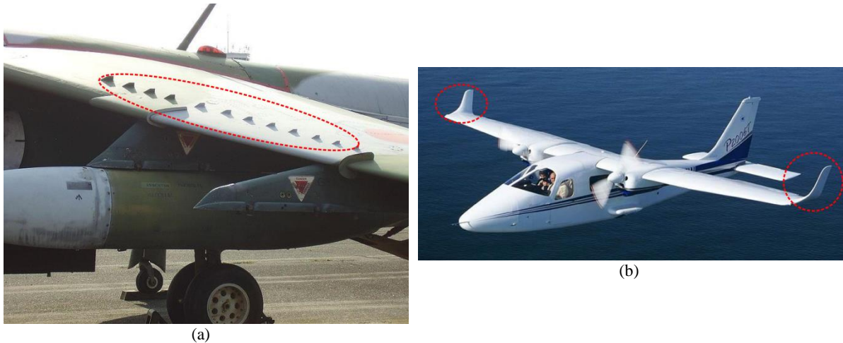
Figure 34. Générateurs de vortex (a) (crédits : Wikimedia Commons); winglets (b) (crédits Winglet Design [58])
