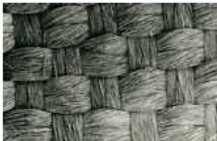
Figure I-11 : Structure microscopique d'une électrode en tissu activé [39].
