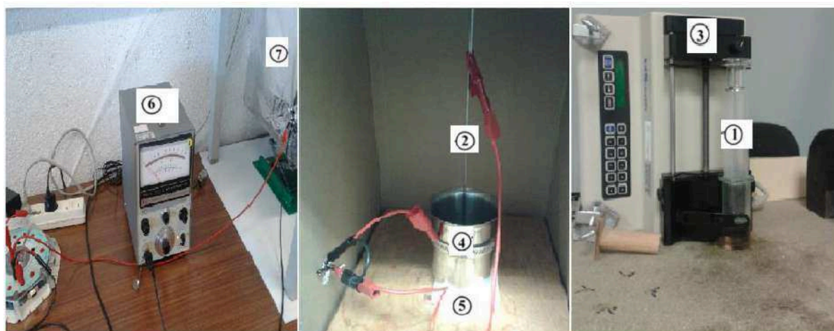
Figure V-1: Schéma de principe de l'électrification de la solution de NaCl en écoulement dans un capillaire en acier inoxydable 304L.
