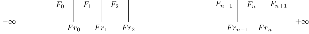
FIGURE VIII.18 – Champ par morceaux F_{\text{Piecewise}} constitué des champs (F_i)_{0 \leq i \leq n+1} et des frontières (Fr_i)_{0 \leq i \leq n} .
