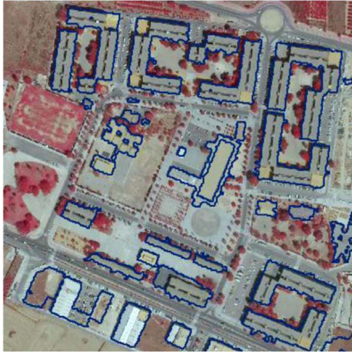
FIGURE 2.14 – Exemple de détection de bâtiments utilisant des données LIDAR et orthophotographie provenant de prises de vue aériennes. Reproduction partielle d’après (Hermosilla et al., 2011, figure 8).
