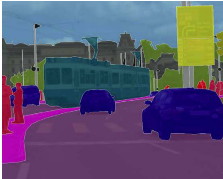
FIGURE 1.11 – Exemple de classification sémantique des objets sur une scène routière. Source publique, DAIMLER.
