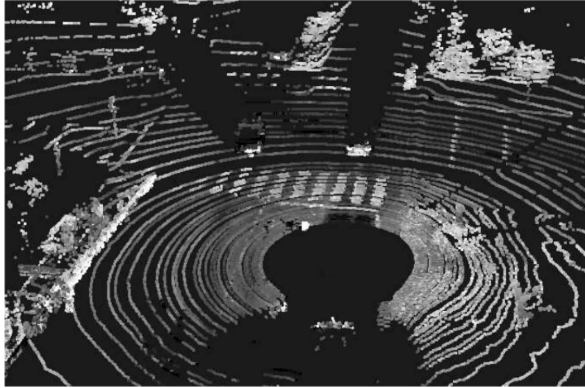
FIGURE 2.8 – Un exemple de données issues à partir d’un LIDAR 3D utilisant 64 nappes LASER. Données reproduites d’après (Levinson and Thrun, 2010, figure 3b).
