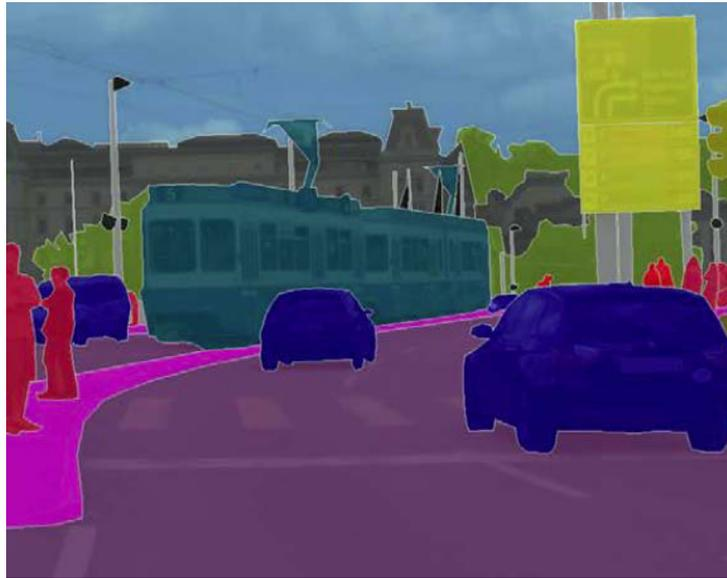
FIGURE 1.11 – Exemple de classification sémantique des objets sur une scène routière. Source publique, DAIMLER.
