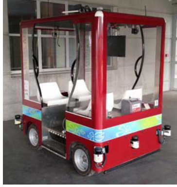
FIGURE 5.11 – Photographie d'un véhicule VIPALAB3 (ici le n°5, équipé de 5 LIDAR), utilisé sur la plateforme PAVIN.
