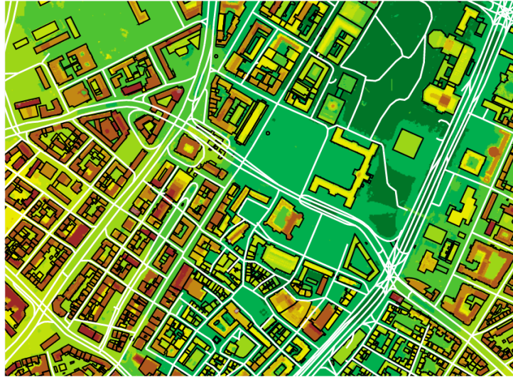
FIGURE 2.13 – Exemple de carte fusionnant des données cadastres et LIDAR (reproduit d’après Brenner and Elias, 2003 , figure 2).
