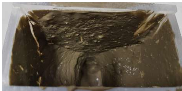
FIGURE V.10 – Réservoir de la moule en plexiglas avec le reste du matériaux de la pâte collée dans les parois dans la pâte P040
