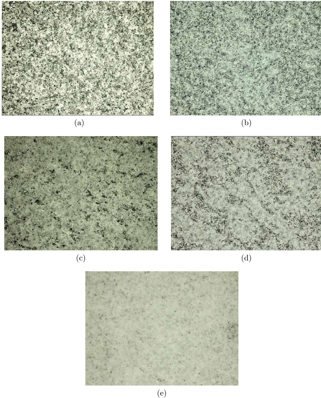
FIGURE III.10 – Images 2D des surfaces des pâtes avec un agrandissement de 500x (taille : 1462 * 1097 \mu m^2 ) : (a) P030, (b) P035, (c) P040, (d) P045 et (e) P050
