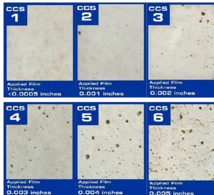
FIGURE I.16 – Effet de la quantité d'huile de démoulage sur l'aspect de parement (Chemical, 2018)
