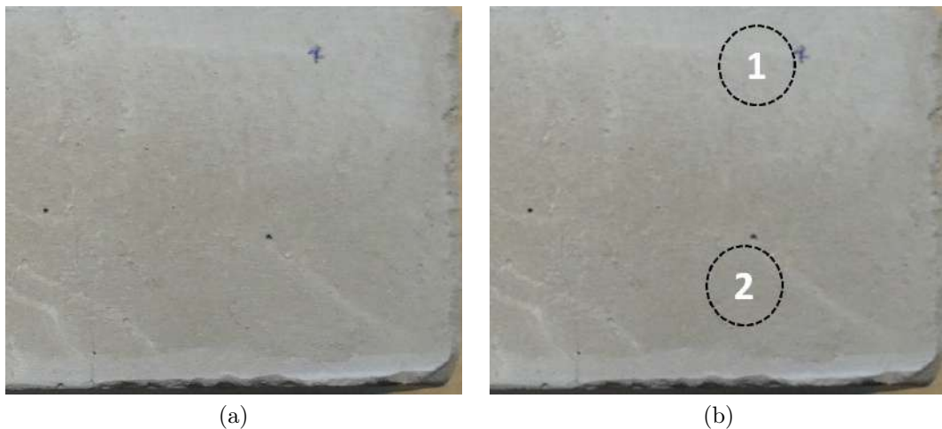
FIGURE G.16 – (a) Surface coffrée d'une pâte de ciment ( E/C=0.40 ) (b) 1 et 2 représentent les points de mesure de rugosité et de clarté
