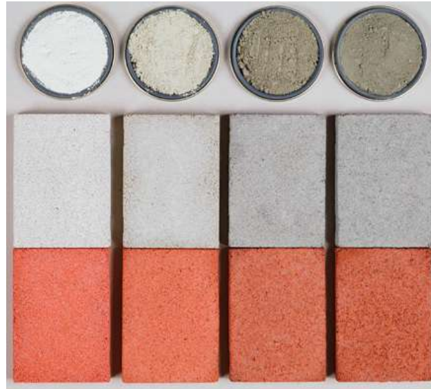
FIGURE I.6 – Variation de la couleur de béton en fonction de la couleur du ciment (Pigments, 2017)
