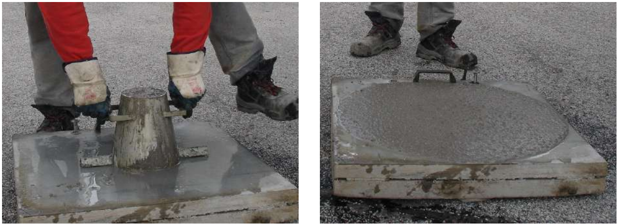
FIGURE II.20 – Essai d'étalement : démoulage (gauche) et mesure des diamètres (droite)
