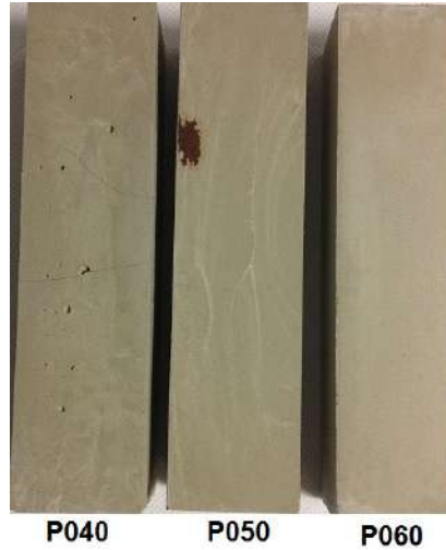
FIGURE V.19 – Variation de la teinte en fonction de rapport E/C : 0.40, 0.50 et 0.60
