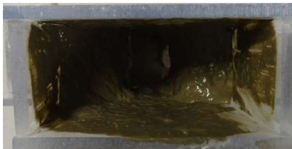
FIGURE V.14 – Réservoir d'une moule en plexiglas avec le reste de matériaux de la pâte collés aux parois (P050)
