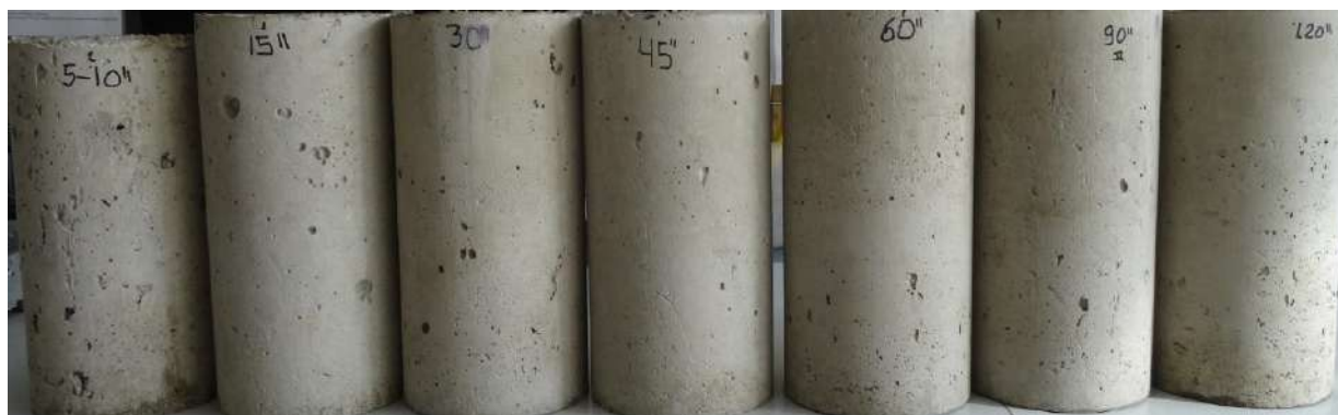
FIGURE G.8 – Variation de la surface des bétons en fonction du temps de vibration
