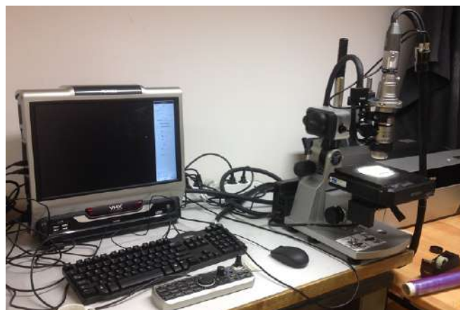
FIGURE III.4 – Microscope numérique "Keyence" au LMT-Cachan
