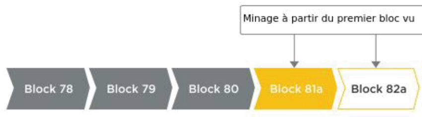
Fig. 5.10: Calcul du nouveau bloc à ajouter en se basant sur le bloc précédent [@Blo]
