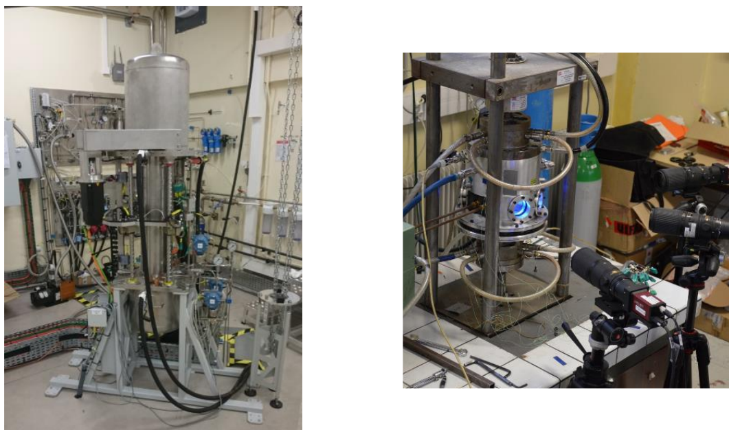
Figure 1.5. (a) Banc expérimental (COCAGNE) et (b) expérience de fluage des éprouvettes de Zircaloy-4.[2].
