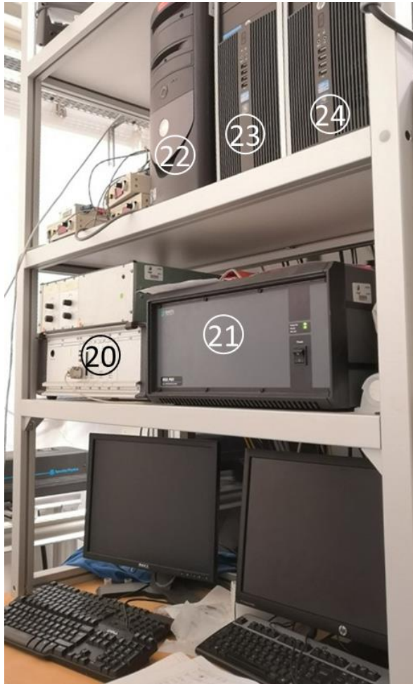
Figure A.4. Photographie de l'installation expérimentale : (20) système de déplacement 3D, (21) processeur P80 (PDA), (22) CPU de pilotage de caméra infrarouge, (23) CPU de pilotage de PDA (24) CPU de pilotage de LIF, (25) Chaîne d'acquisition de signal LIF
