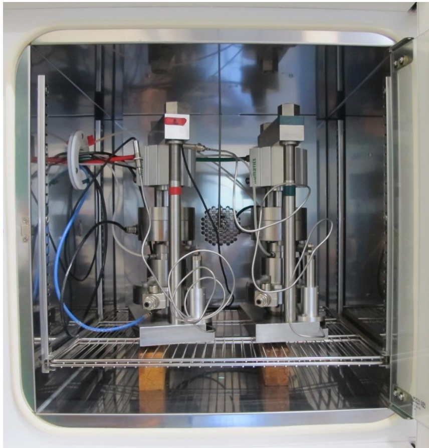
Figure 2.12. Imposition et control de température : œdomètres placés à l'intérieur de l'enceinte.
