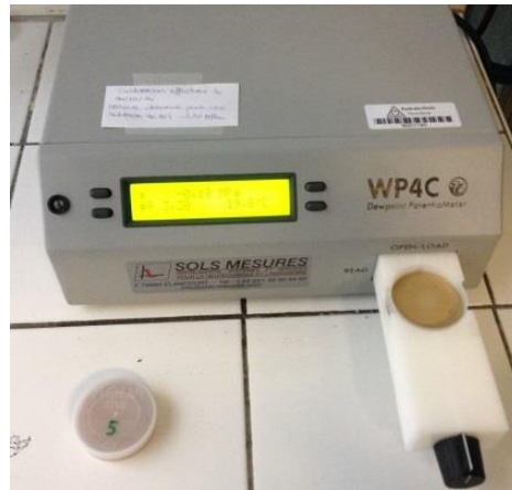
Figure 2.4. Mesure de la succion avec le potentiomètre.
