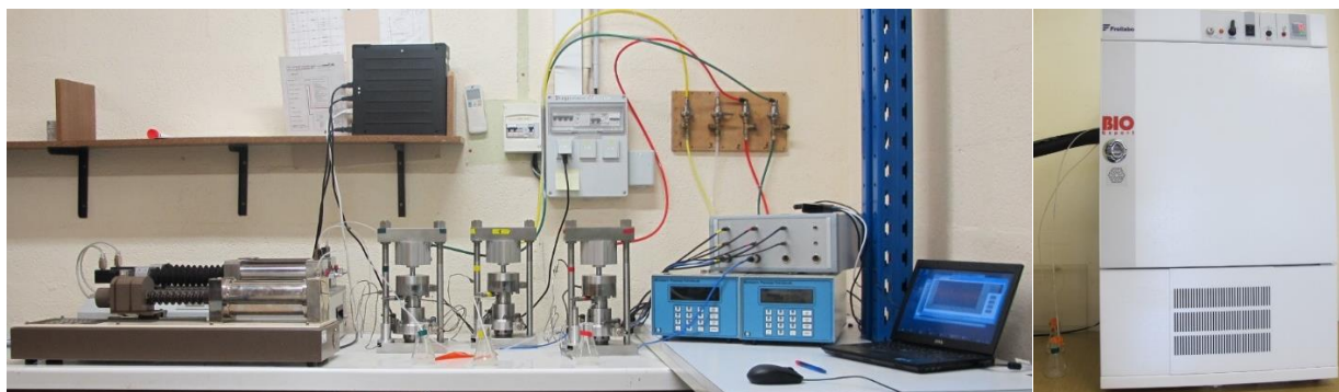
Figure 2.9. Vue de l'ensemble du système expérimental, essais œdométriques de fluage à 20°C. De gauche à droite : deux contrôleurs volume-pression, onduleur, trois cellules œdométriques montées sur leurs bâtis, cellule d'acquisition, régulateurs de pression d'air comprimé connectés à des vannes de contrôle, ordinateur, enceinte climatique.
