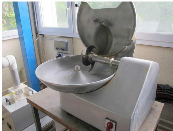
Figure 2.1. Malaxeur à couteaux utilisé pour homogénéiser le mélange.
