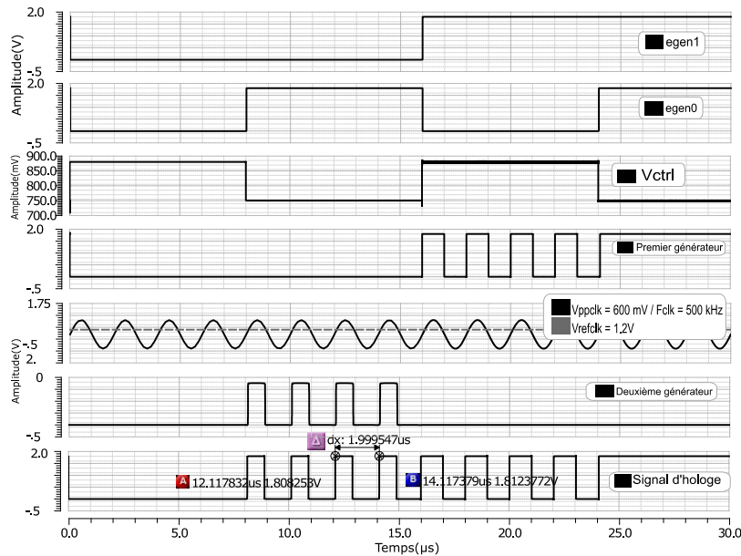
Figure 4. 20 Simulations de l'étage de génération du signal d'horloge la fréquence 500 kHz.
