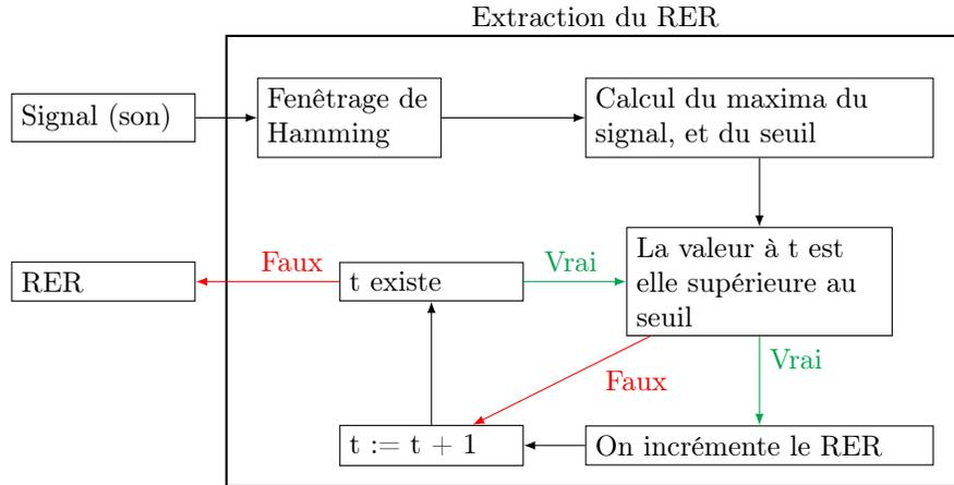
FIGURE 2.9 – Schéma des différentes étapes d'extraction du RER
