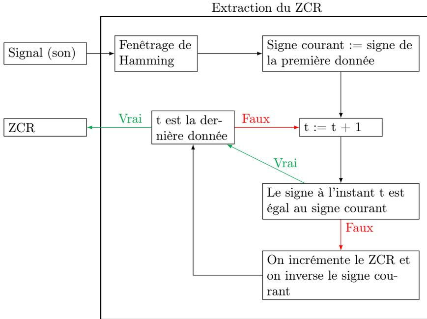
FIGURE 2.8 – Schéma des différentes étapes d'extraction du ZCR
