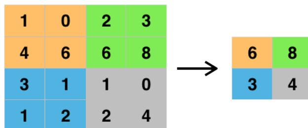
FIGURE 5.5 – Exemple de traitement d'une couche d'union par maximum (*Max-Pooling*)
