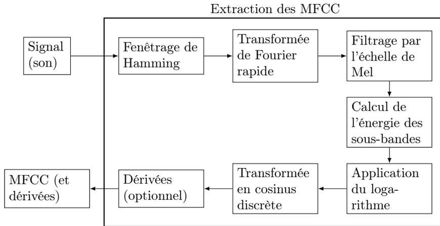
FIGURE 2.5 – Schéma des différentes étapes d'extraction des MFCC
