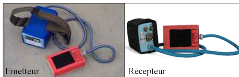
Figure 4.5 : Dispositif de mesure utilisé sur les corps d'épreuves
