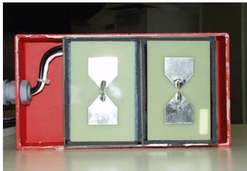
Figure 2.4: Antenne dipolaire ouverte utilisée pour les mesures : Position des dipôles dans la boîte de blindage
