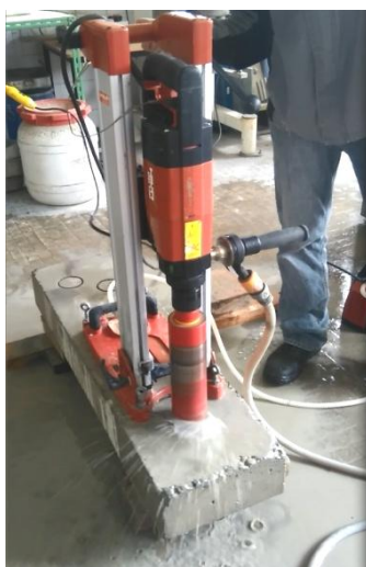
Figure 4.8 : Carottage sous eau du corps d'épreuve D3
