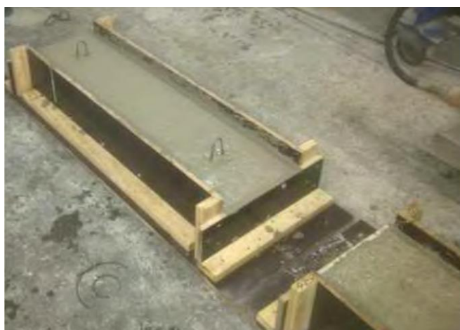
Figure 4.2: Coulage des corps d'épreuves D2 et D3
