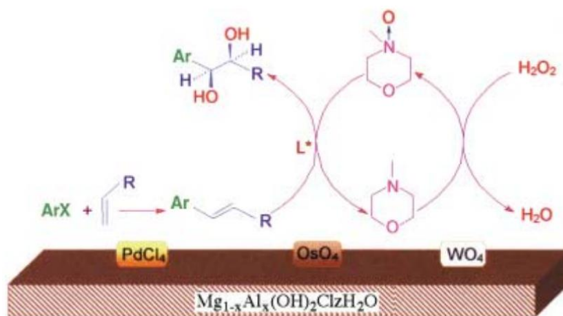
Figure I-57 : Représentation schématique du cycle catalytique de la synthèse de diols chiraux en combinant trois catalyseurs chimiques.
