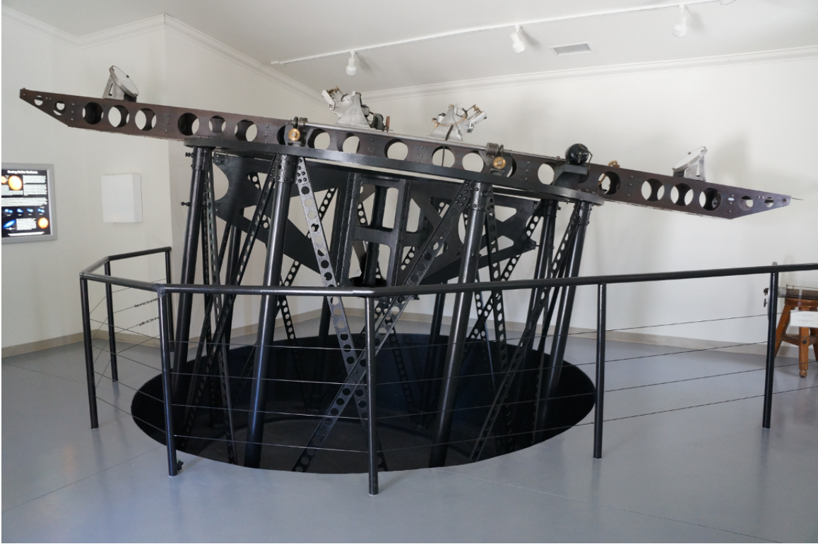
FIGURE 1.17 – L'interféromètre stellaire de Michelson ayant été utilisé sur le télescope de 100 pouces à l'observatoire du Mont Wilson. Ce dispositif a permis, entre autre, de résoudre angulairement des étoiles telles que Bételgeuse et Antares (Photo de l'auteur)
