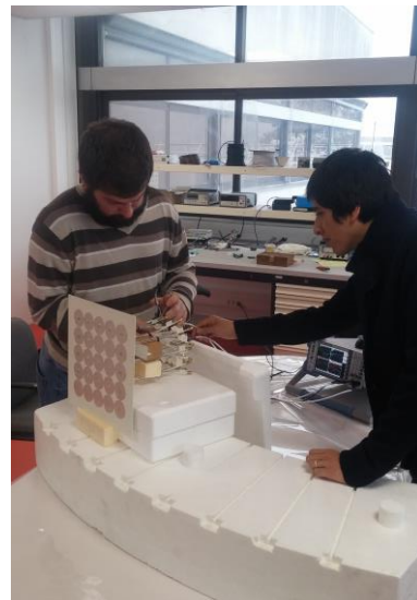
Figure 8 Mesure des paramètres S du prototype du réseau de spirales non complémentaires à quatre bras connectés.
