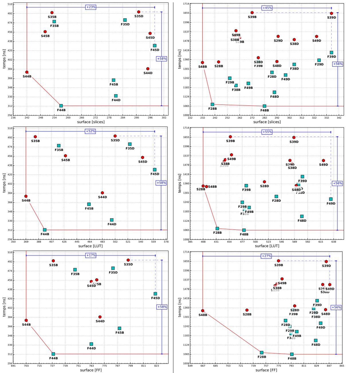
FIGURE 3.22 – Compromis surface – temps des HTMM spécifiés et implantés sur V5 pour trois différentes métriques de surface du FPGA : *slices* logiques, LUT et FF.
