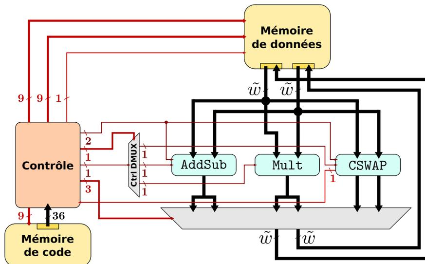
FIGURE 4.2 – Architecture A1 avec ses principales unités (arithmétiques et mémoire), le réseau d’interconnexion interne et le contrôle (les surfaces des différents blocs ne sont pas à l’échelle).
