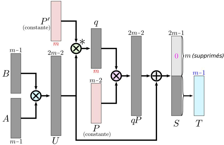
FIGURE 3.6 – Illustration des opérations dans la MMM [Mon85] optimisée par Walter [Wal99a] (sans soustraction finale) pour la valeur minimale de  $m$ , à savoir  $m = n + 2$ . La multiplication marquée « \* » est calculée modulo  $2^m$  (seuls les  $m$  LSB de  $U$  sont utilisés).
