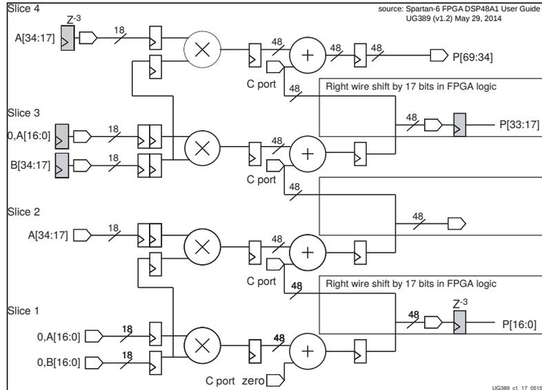
FIGURE 3.5 – Multiplieur  $35 \times 35$  bits pipeliné à base de *slices* DSP organisés en cascade. Le schéma est tiré du document [Xil11] de Xilinx.
