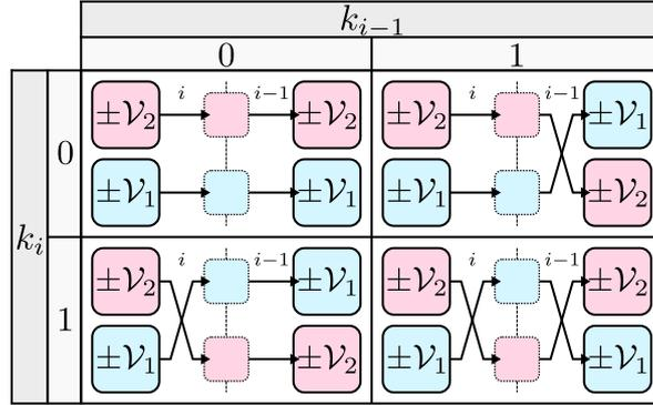
FIGURE 4.3 – Permutation des opérandes  $\pm\mathcal{V}_1$  et  $\pm\mathcal{V}_2$  dans l’unité **CSWAP-v2** en fonction de la valeur des bits  $k_i$  et  $k_{i-1}$  du scalaire.
