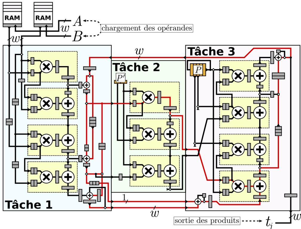
FIGURE 3.11 – Architecture du HTMM 128 bits de [GT17d] pour  $\sigma = 3$  et  $s = 4$  (sans le détail du contrôle). Les rectangles bleus, verts et rouges représentent les blocs matériels pour chaque tâche dans l’Algo. 14. Les rectangles jaunes sont les *slices* DSP (avec le détail du pipeline interne) et les gris sont les registres. Le chemin critique dans la boucle externe est en rouge.
