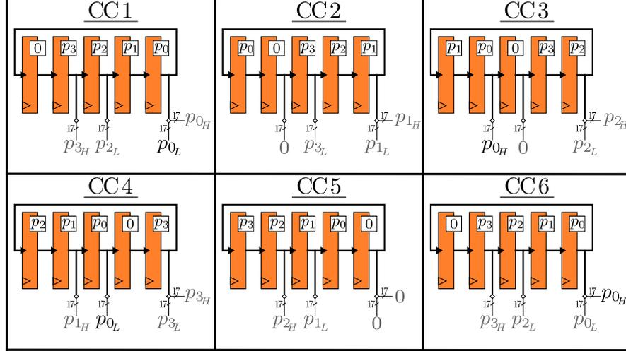
FIGURE 3.12 – Illustration du fonctionnement du *buffer* circulaire servant au stockage de  $P$  dans le bloc 3 du HTMM de [GT17d]. Le cycle d’horloge « CC 1 » correspond au début du calcul de  $q_i \times p_0$  dans le premier *slice* DSP du bloc matériel pour la tâche 3.
