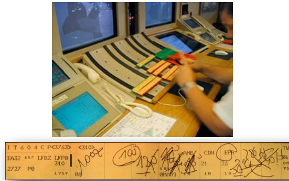
Figure 129: une position de contrôle aérien en France, basée sur une image radar et un tableau de strips papier
