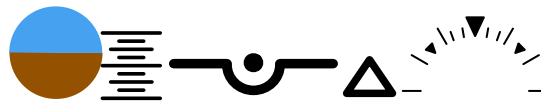
Figure 150: éléments graphiques des indicateurs d'attitude : horizon, échelle d'assiette, maquette avion, pointeur, échelle d'inclinaison
