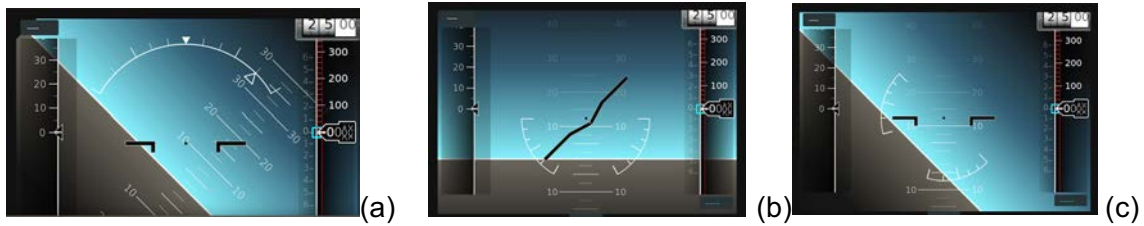
Figure 149: prototypage rapide de la dynamique des trois visualisations occidentale (a), russe (b) et combinée (c), à forte inclinaison, grâce à l'utilisation de djnn
