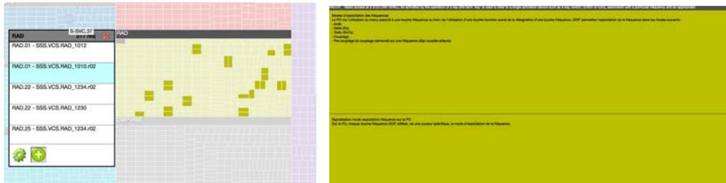
Figure 106: la liste des exigences filtrées (à gauche) permet de naviguer d'exigence en exigence dans le treemap (à droite)
