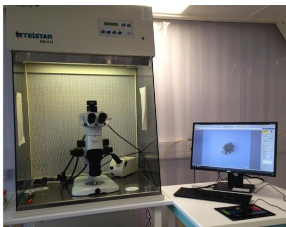
FIGURE 2.5 – Photo prise dans la salle blanche de classe ISO 7, représentant la loupe binoculaire et la hotte à flux laminaire de classe ISO 5. La loupe binoculaire est équipée d'une caméra optique permettant la visualisation des échantillons sur l'ordinateur.
