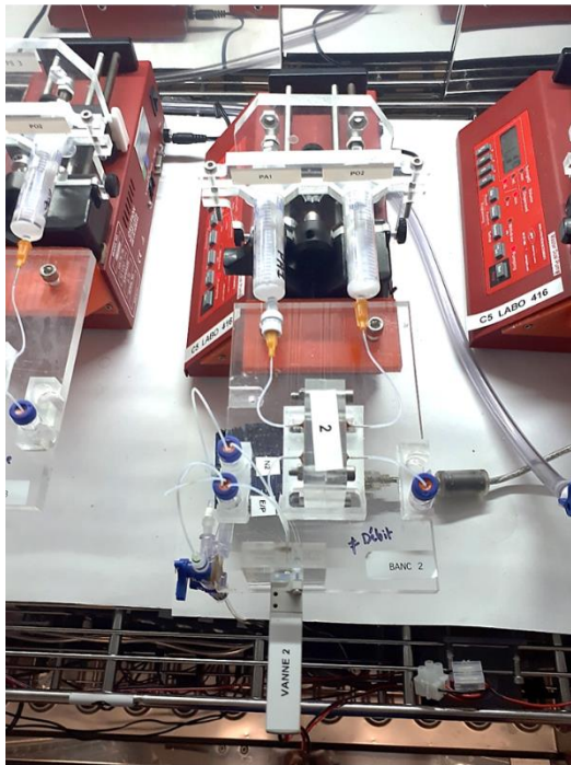
Figure 42: Banc expérimental d'extraction avec contrepression
