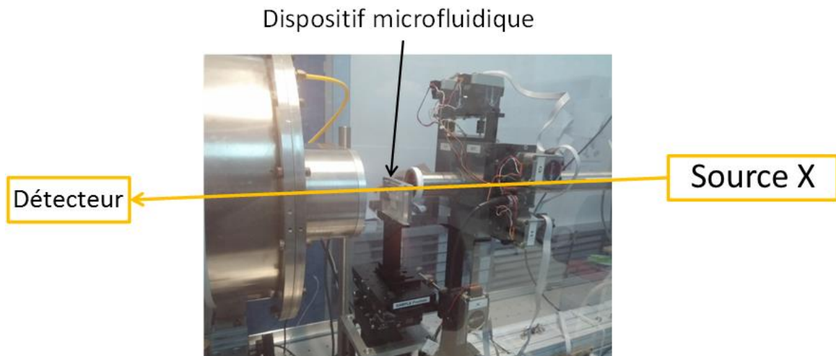
Figure 81: Test du dispositif microfluidique sur le SAXS de l'ICSM
