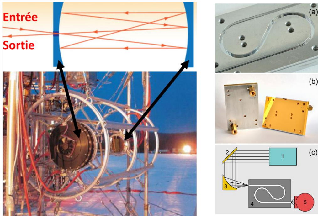
Figure 96: à gauche cellule d'analyse gaz Herriot et à droite guide d'onde iHWG 118
