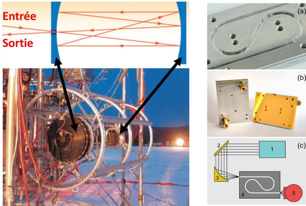
Figure 96: à gauche cellule d'analyse gaz Herriot et à droite guide d'onde iHWG<sup>118</sup>
