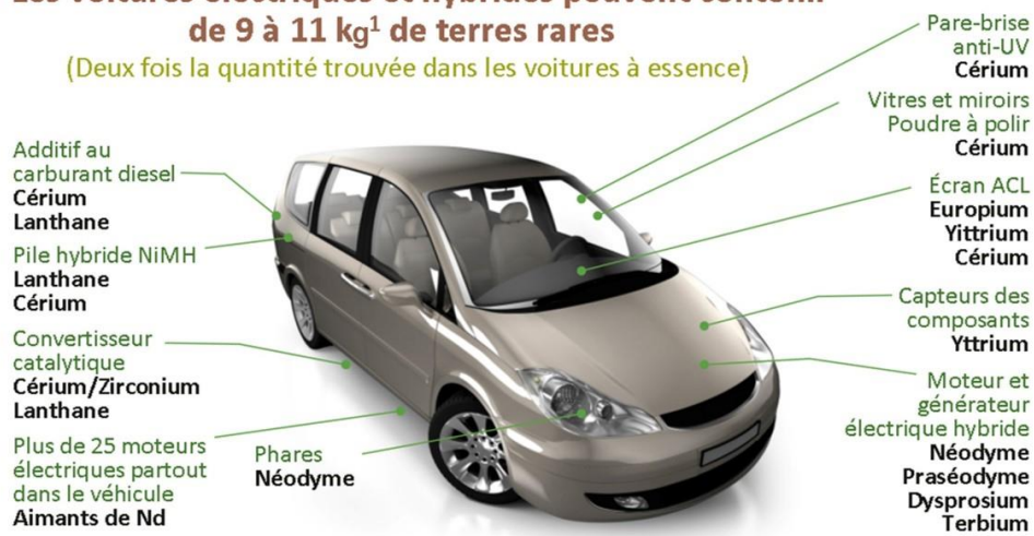
Figure 3: Utilisation des terres rares dans un véhicule électrique ou hybride, extrait et adapté 6
