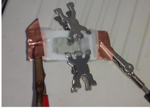
FIGURE 7.3 – Photographie du dispositif utilisé pour l'électroformation de vésicules de phospholipides.
