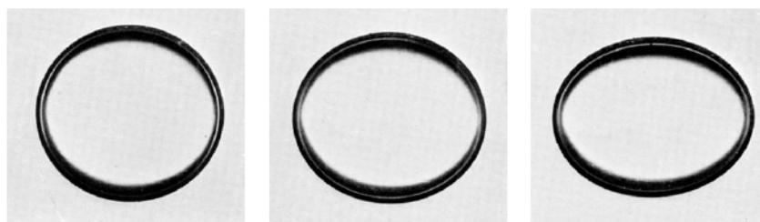
FIGURE 1.3 – Déformation sous champ électrique d'une goutte d'huile silicone en suspension dans de l'huile de ricin. Le champ électrique augmente de gauche à droite. Le rayon de la goutte non déformée est R_0 = 0.6\text{mm} . Issue de [32].
