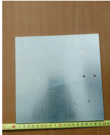
FIGURE 3.19 – Photographie de la plaque métallique carrée de longueur 200 mm .
