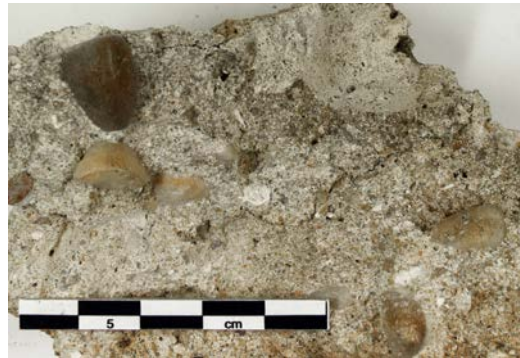
Fig. 4 – Mortier contenant des quartz de grande dimension, château de Romont, 88 (cliché Cédric Moulis).
