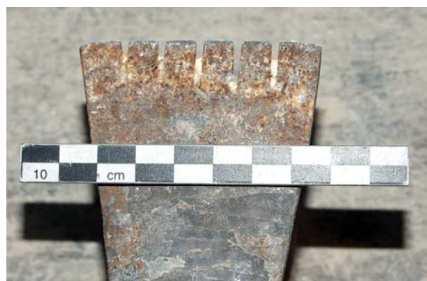
Fig. 35 – Brettature utilisée pour l'expérience (cliché Vianney Muller).
