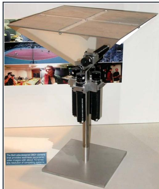
Figure 9 : Caméra 360° utilisée dans le projet DIVER (Source site fullview)<sup>33</sup>
