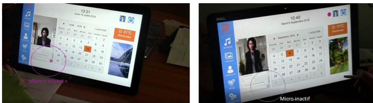
Figure 50: Modification de la couleur de l'icône "micro" pour informer de l'état du système vocal
