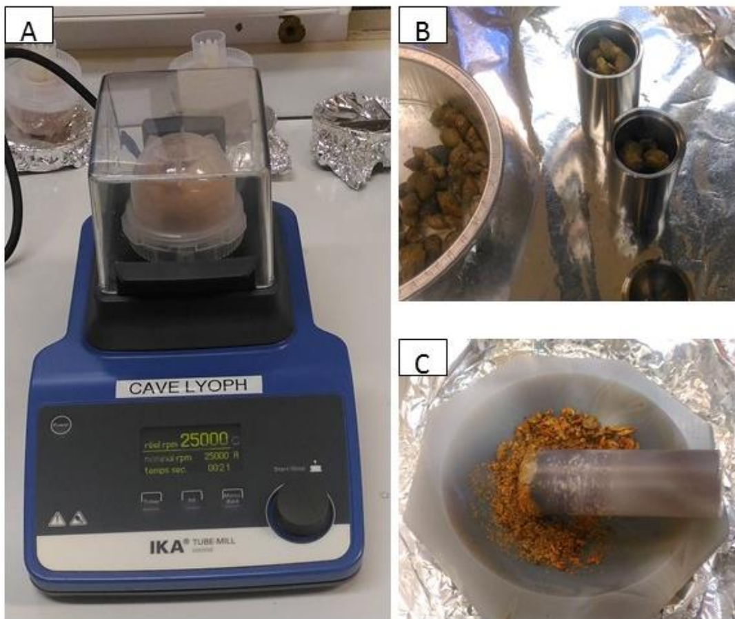
Figure 34 : Systèmes de broyage des échantillons de biote utilisés au LPTC. A : broyeur IKA, B : tubes du broyeur à billes, C : mortier.
