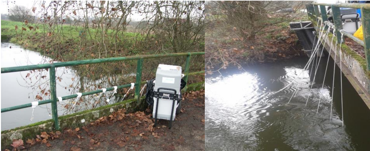
Figure 38 : Position du préleveur automatique et des cages renfermant les POCIS lors de la calibration in situ .
