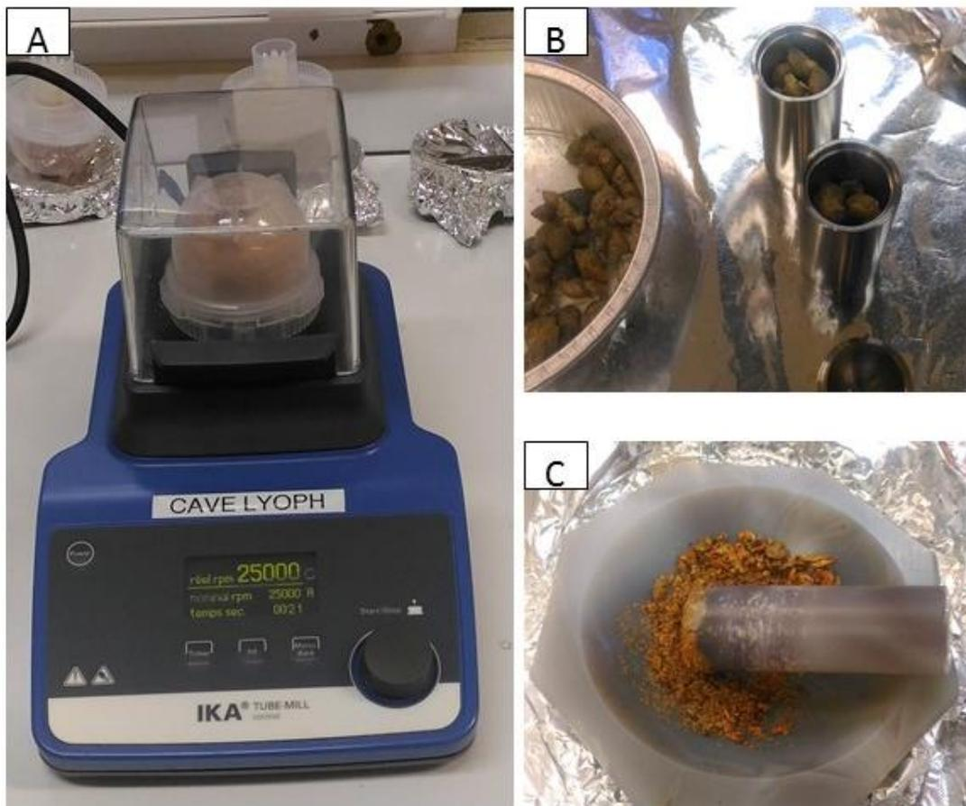
Figure 34 : Systèmes de broyage des échantillons de biote utilisés au LPTC. A : broyeur IKA, B : tubes du broyeur à billes, C : mortier.
