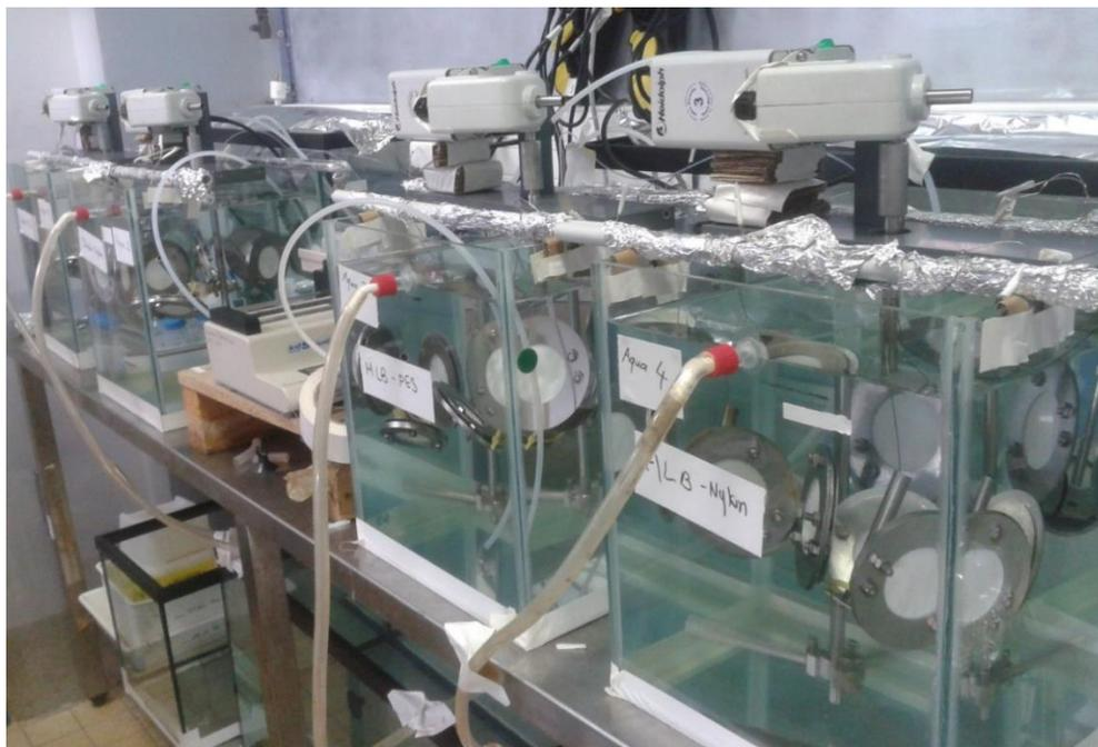
**Figure 36 : Dispositif expérimental d'exposition des POCIS**
