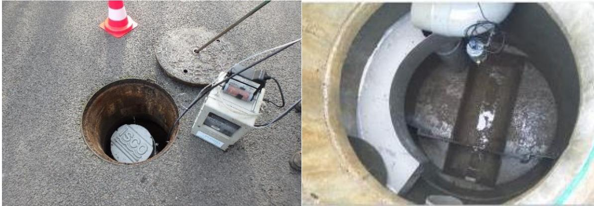
**Figure 30 : Photos illustrant le prélèvement en réseau d'assainissement (à gauche une canalisation d'eaux usées et à droite une canalisation d'eaux pluviales). M.J. Capdeville (2015, rapport non publié)**
