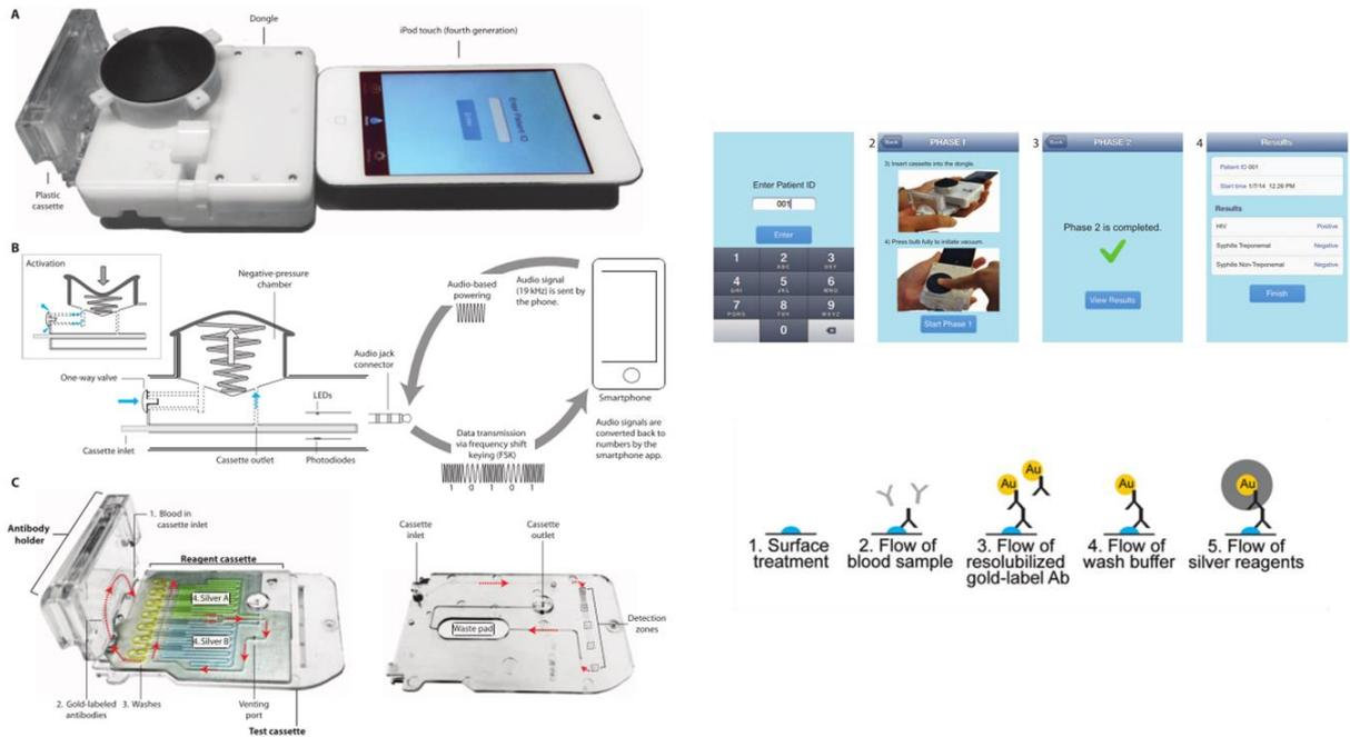
Figure I-32: Exemple d'un dispositif portable utilisant un smartphone pour mesurer la concentration d'hémoglobine et détecter des anticorps contre le VIH [50].
