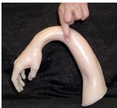
Figure II-43: Matériau « Ecoflex® » hyperélastique.
