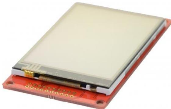
Figure V-18: Image de l'écran tactile (Watterott mi0283qt-2).
