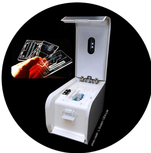
Figure II-1: A : Cartes microfluidiques et instrument pour piloter ces cartes (plateforme Flowpad).
