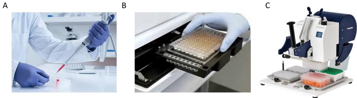
Figure I-13: Outils utilisés pour réaliser un test ELISA en laboratoire A: Opération de pipetage, B: Plaque 96 puits, C : robot pipeteur [18].
