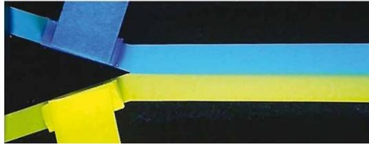
Figure II-21 : Exemple d'écoulement laminaire [90].
