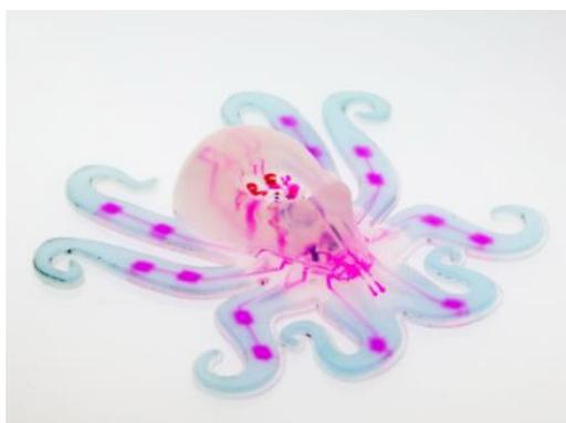
Figure II-42: Utilisation de l'Ecoflex® pour la fabrication de robots souples [99].
