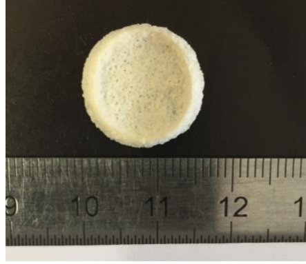
Figure 68 : Membrane de chitosan et d'alginate préparée par sédimentation et évaporation dans une plaque de 12 puits.
