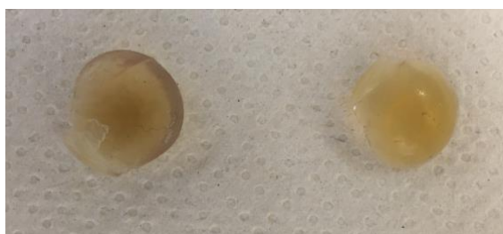
Figure 48 : CoPEC chitosan/alginate préparés par ultracentrifugation.
