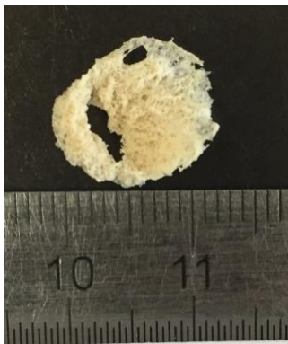
Figure 75 : Membrane de \beta CD-chitosan et d'alginate préparée par sédimentation et évaporation dans une plaque de 24 puits.
