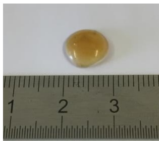
Figure 53 : CoPEC \beta CD-chitosan/alginate préparé par ultracentrifugation.
