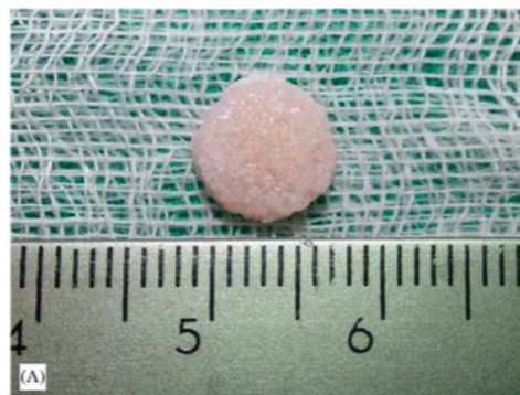
Figure 13 : Échafaudage à base d'acide poly(lactique-co-glycolique) et d'hydroxyapatite,ensemencé d'ostéoblastes, pour l'ingénierie osseuse. Selon Kim et al. 43
