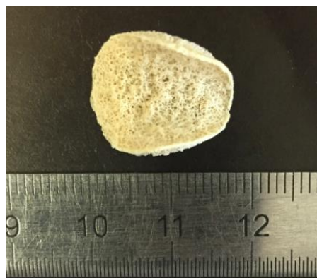
Figure 71 : Membrane de \beta CD-chitosan et d'alginate préparée par sédimentation et évaporation dans une plaque de 12 puits.
