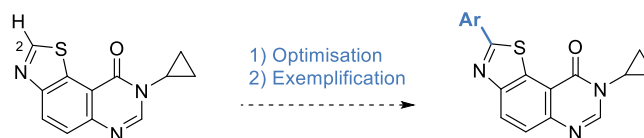
Schéma II-33 : Second objectif : optimisation puis exemplification de l'arylation directe en C2 de la 8-cyclopropylthiazolo[5,4- f ]quinazolin-9(8 H )-one.
