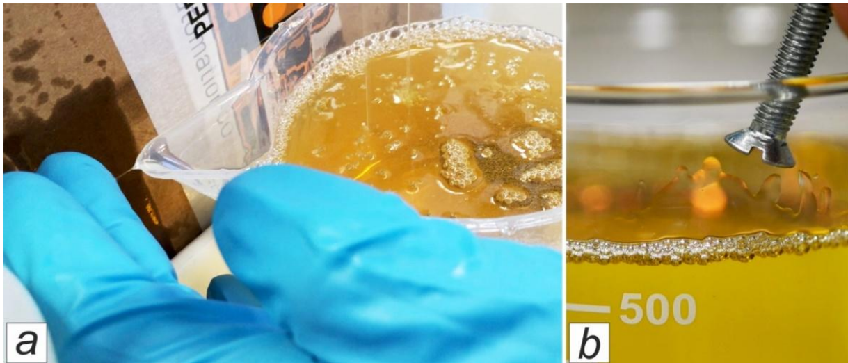
Figure 2-19. Effet électrostatique : a) l'huile attirée par un doigt, b) mouvement ascendant de l'huile dans un bécher en verre attirée par une vis.
