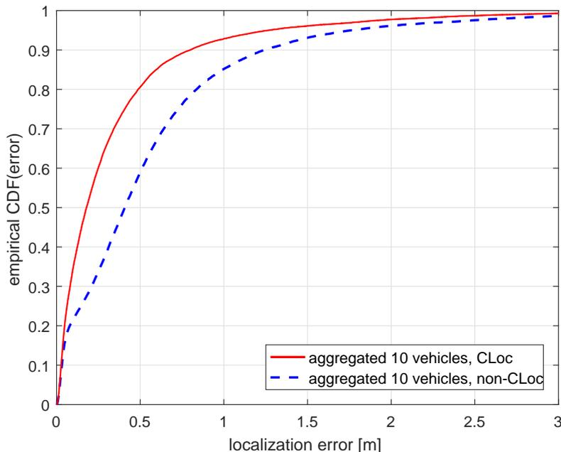
Figure 9.22: CDF empirique d’erreur de positionnement (aggrégée sur l’ensemble des 10 véhicules) pour une fusion VA-CLoc {GNSS+WSS+IMU+UWB} (rouge) et un positionnement *standalone* {GNSS+WSS+IMU} (bleu) dans le scénario SUMO simulé dans la ville de Bologne de la Figure 9.21.
