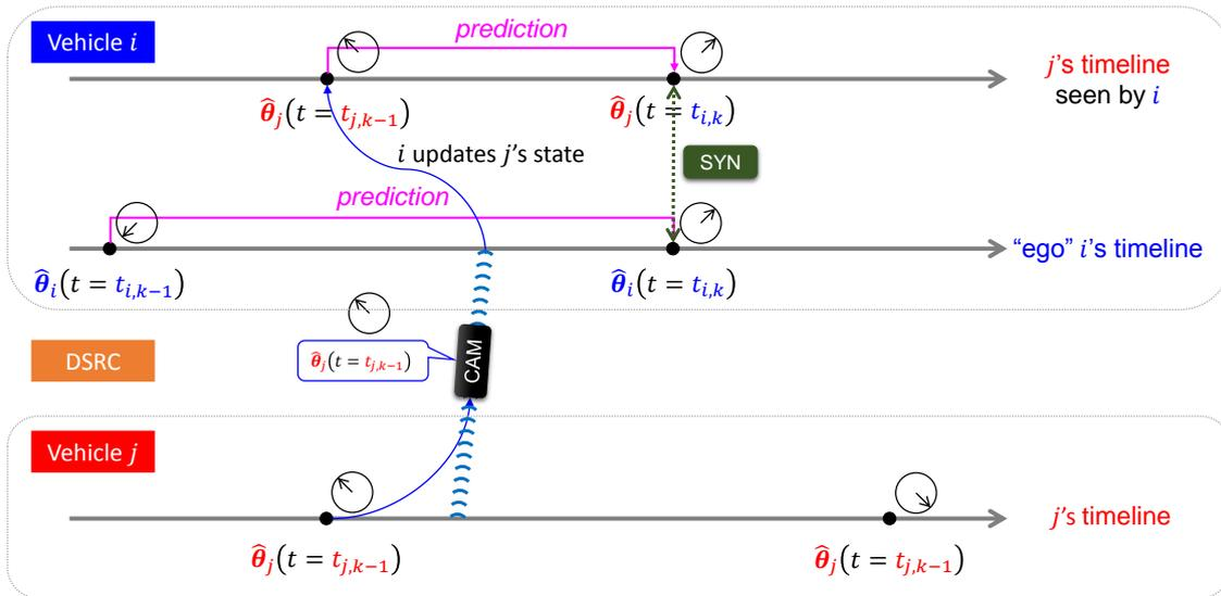
Figure 9.6: Exemple de gestion temporelle des données CLoc au niveau du véhicule "Ego"  $i$  (en charge de la fusion) vis-à-vis du véhicule voisin  $j$ . En raison de l'asynchronisme des quantités estimées  $\hat{\theta}_i(\cdot)$  et  $\hat{\theta}_j(\cdot)$ , le véhicule  $i$  doit réaliser une prédiction afin de "resynchroniser" à l'instant de fusion  $t_{i,k}$  l'ensemble des données (y compris les informations reçues de la part du voisin).
