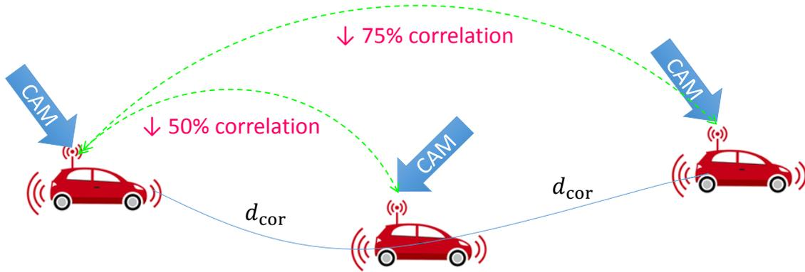
Figure 9.12: Illustration de la réduction délibérée du taux de fusion permettant de collecter des échantillons V2V RSSI non-corrélés.
