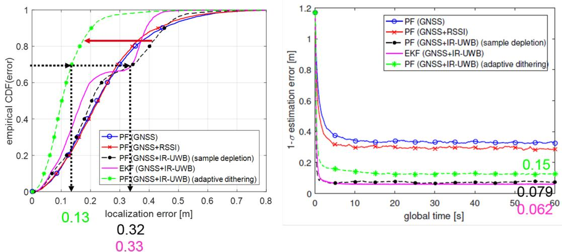
Figure 9.19: CDF empirique de l'erreur de positionnement issue de la fusion ITS-G5/GNSS/IR-UWB et erreurs caractéristiques effectives à  $1\text{-}\sigma$  (c.-à-d. à CDF=68%), pour différentes stratégies de filtrage (gauche) et évolution de l'erreur à  $1\text{-}\sigma$  perçue au niveau des filtres, en fonction du temps (droite).
