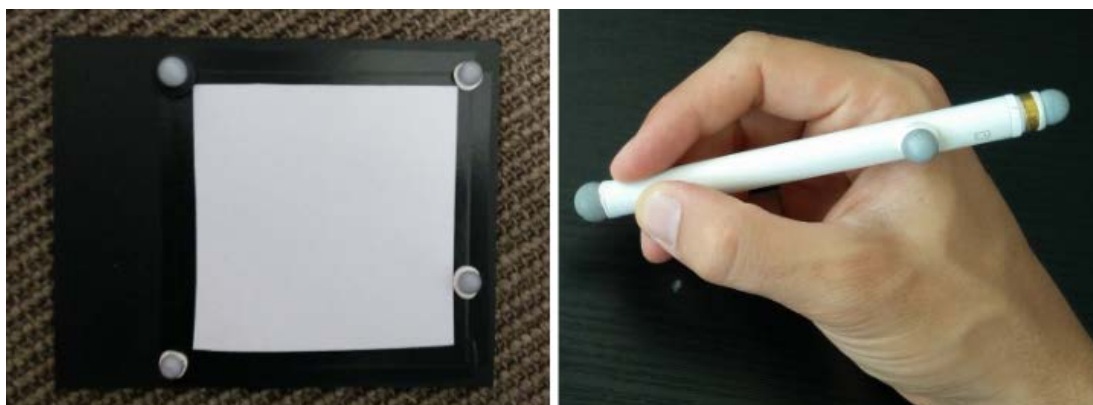
Figure A.8 – Outils d’interaction tangibles de MoSART: le panneau interactif (gauche) et le stylet interactif (droite).
