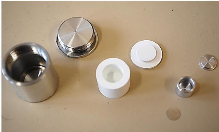
FIGURE 6.17 – Photographie des trois boîtiers. De droite à gauche : le premier boîtier en aluminium, le boîtier en nitrure de bore et le second boîtier en aluminium
