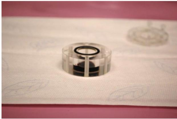
FIGURE 6.21 – Conteneur en plexiglas contenant la solution de chlorure de rhodium liquide
