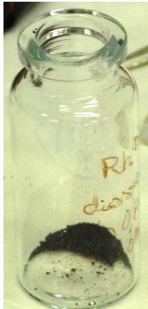
FIGURE 6.15 – Chlorure de rhodium sous forme cristalline
