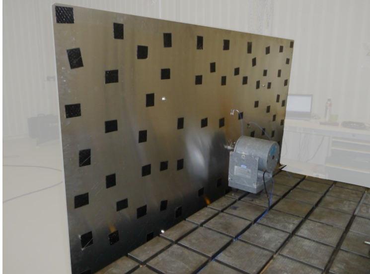
FIGURE 2.8 – Montage expérimental d'une plaque d'aluminium excitée par un pot vibrant.
