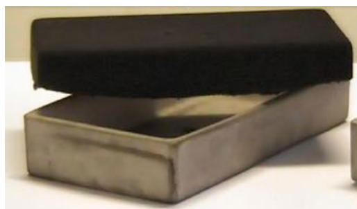
Figure 2-2 : Poudre nanocomposite (friable) obtenue après la synthèse à la sortie du four de CCVD.
