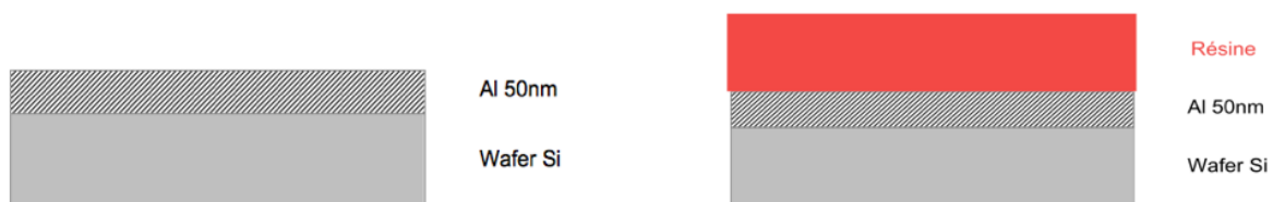
FIGURE 1.11 – Vue en coupe schématique des différentes couches.
